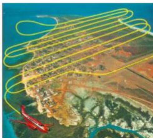
**Figure 6: Plan de vol et d'acquisition (Michel-Villaz, 2008)**
