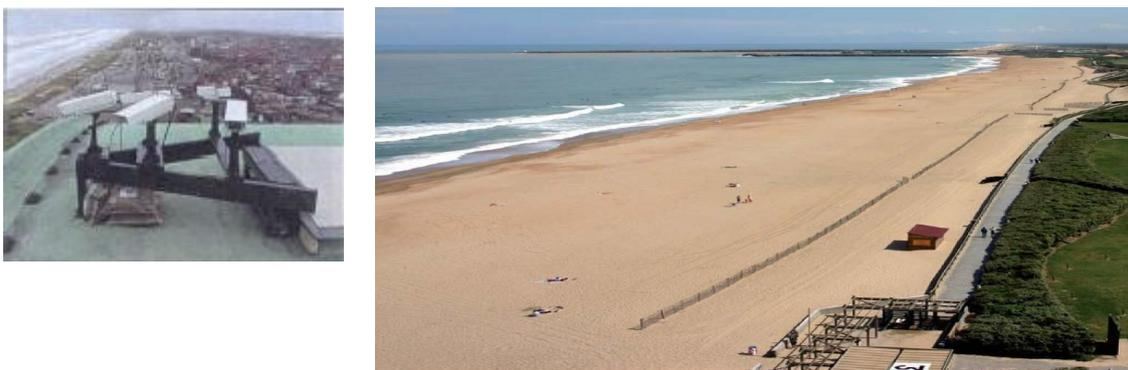
**Figure 23: Suivi du littoral par vidéo surveillance (Lesagec, 2006)**
