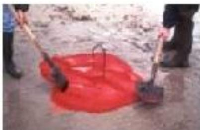
**Figure 24: Pose d'un traceur**
